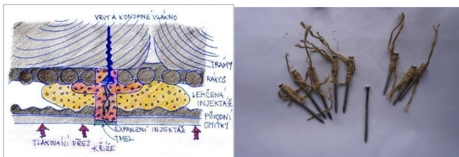
Obrázek 19 Injektáž dřevěného stropu s rákosovým podbitím na zámku v obci Hradištko. Pojistné kotvy jsou vruty s konopným vláknem osazené do mírně expanzní malty.
