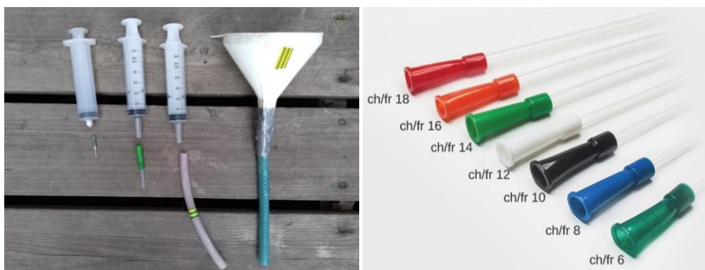
Obrázek 4 Nalevo různé typy vybavení na injektaži. Napravo katetrovací hadičky.
